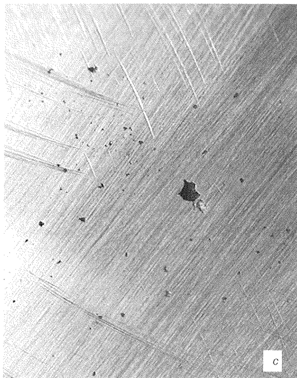
Figura 7.7. Réplicas experimentales: A) Deformaciones producidas por golpe penetrante. B) Sucesivas pruebas de fundido. C) Microburbujas asociadas al proceso de fundición.
